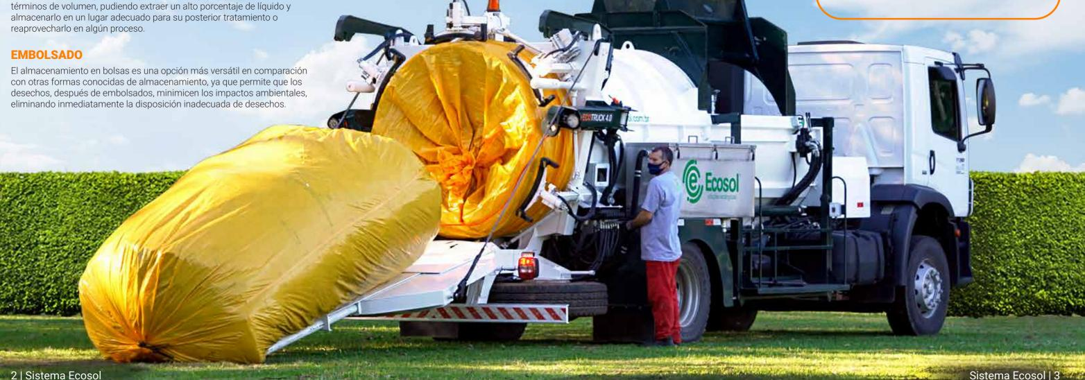
El Sistema Ecosol está compuesto por un Ecotruck y unos equipos auxiliares que permiten el movimiento y optimización del proceso de embolsado.
